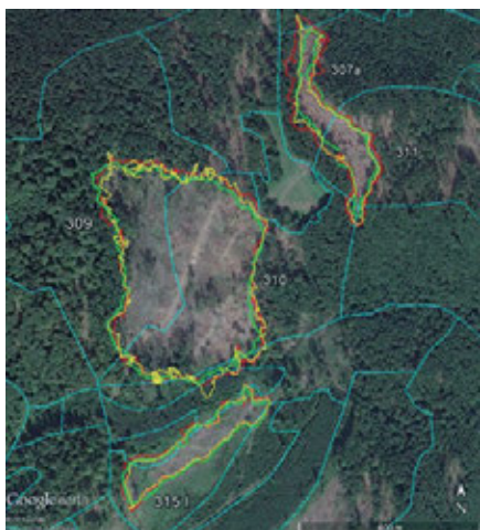
Obr. 1 Priebeh okrajov súvislých kalamitných plôch zameraných GNSS zariadeniami v lokalite Potoky (ZTE Blade, LG G2, Trimble Nomad 900)
