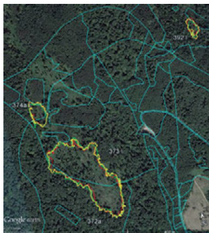
Obr. 2 Priebeh okrajov súvislých kalamitných plôch zameraných GNSS zariadeniami v lokalite Krigrund (ZTE Blade, LG G2, Trimble Nomad 900)
